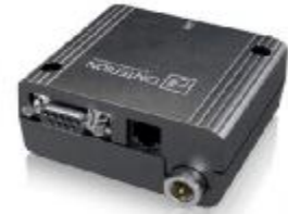
GSM/GPRS модем с RS-232 интерфейсом
