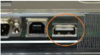
Интерфейс USB-Host (USB Тип A)
