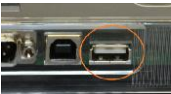
Интерфейс USB-Host (USB Тип A)
